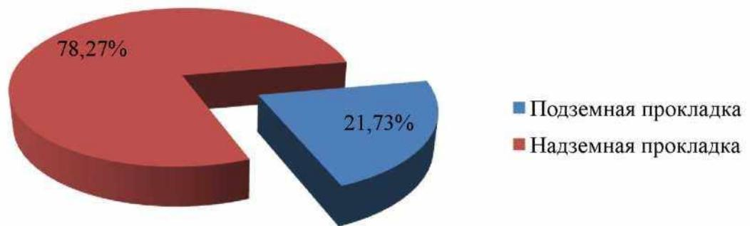
Рисунок 2.3.2.1 - Доли протяжённости участков трубопроводов тепловых сетей от котельных МУП «Масальское ТС» различных видов прокладки
