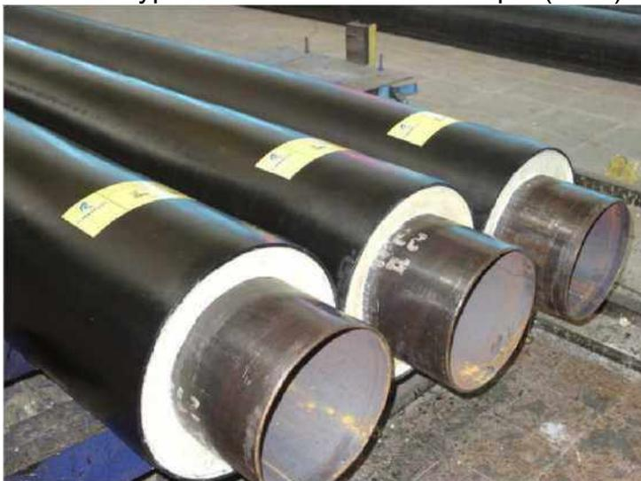
Рис.10.Теплоизоляция ППУ «скорлупа»
