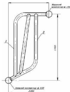
Рис. 1. Поперечный разрез котла НР-18 с пакетом из прямых труб.
