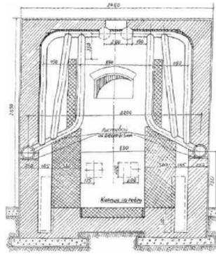
**Рис. 4. Поперечный разрез котла HP-18 с пакетом из гнутых труб**
